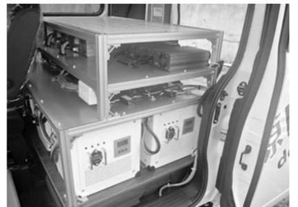
電源車に搭載している2500Wh/200Ahリチウムイオンバッテリー
