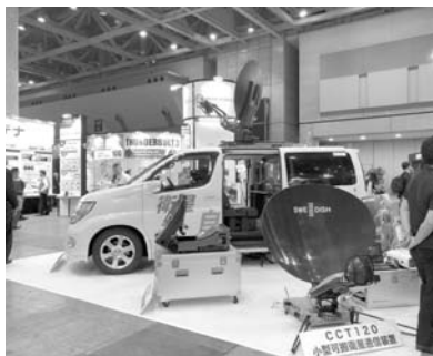
エルグランド車両にコブハム社製アンテナを搭載した「エコ衛星中継車」
