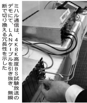
ミハル通信は、4K8K高度BS試験放送のデモにて、LANケーブルを引き抜き、無断で切り換える冗長性を示した
